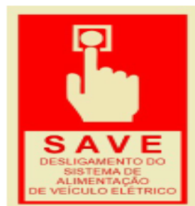
Figura 5: Sinalização de chave de desligamento de emergência
